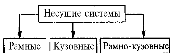
Рис. 36.1 Типы несущих систем
